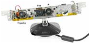
Dispositivo Microsoft Kinect, hardware de captura de movimiento
